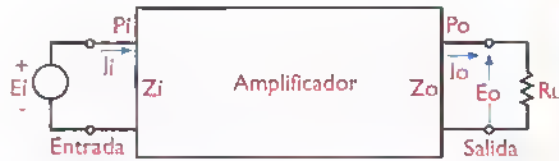
Figura 8.19. Diagrama de bloques de un amplificador genérico. El subíndice «i» (input) denota condiciones de entrada, y el subíndice «o» (output) condiciones de salida. Por ejemplo, I_i es la corriente de entrada y P_o es la potencia de salida.
